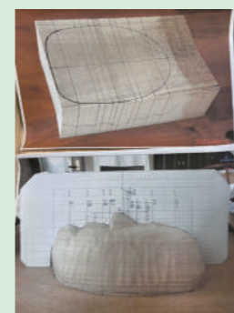
【上段】彫り始める前の一枚板 【下段】計算して作られた図面に合わせて立体的に彫ります
